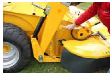
A központi vonórúddal a traktor mindkét oldalán dolgozhat.
