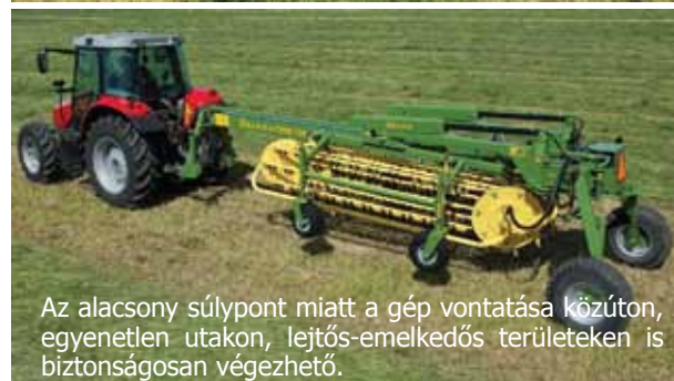
A gépek rotorjainak központi csapos függesztése a Hydro Balance hidro-pneumatikus csillapítással együtt, kiváló talajkövetést eredményeznek.
